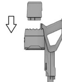
**Nota:** Para prolongar la vida útil de la batería, cárguela cuando esté casi agotada. No cargue o guarde el artefacto en lugares con temperaturas por debajo de 0°C o superiores a 40°C ya que podría dañarse. Durante la carga, la temperatura del artefacto podría aumentar. Se trata de un fenómeno normal.
