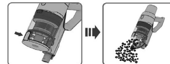
**DESMONTAR EL COLECTOR DE POLVO**
